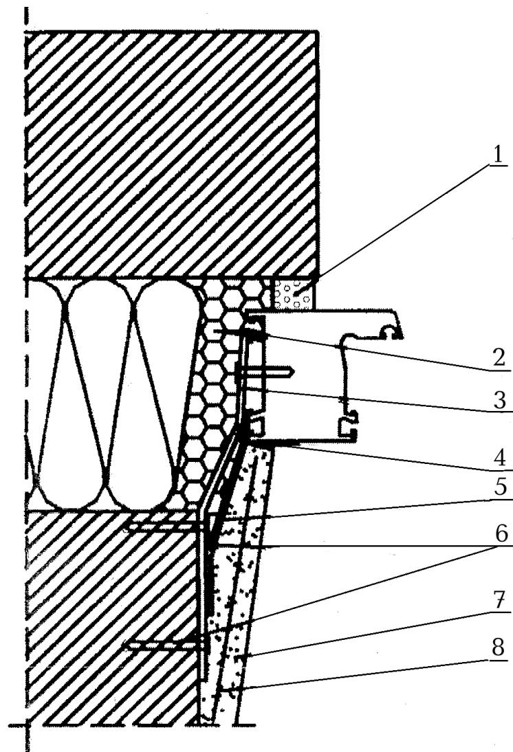
1 – изоляционная саморасширяющаяся паропроницаемая лента; 2 – пенный утеплитель; 2 – гибкая анкерная пластина; 4 – герметик; 5 – пароизоляционная лента; 6 – дюбель со стопорным шурупом; 7 – штукатурный слой внутреннего откоса (с фаской для слоя герметика); 8 – армирующая сетка
