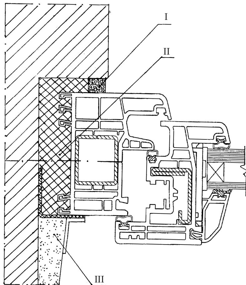
I – наружный водоизоляционный паропроницаемый слой;
