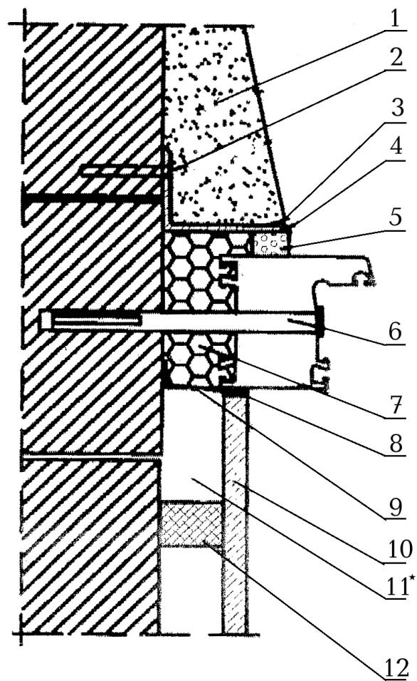
1 – штукатурный слой наружного откоса (с фаской для слоя герметика); 2 – строительный шуруп; 3 – герметик; 4 – фальшчетверть из уголка; 5 – изоляционная саморасширяющаяся паропроницаемая лента; 6 – рамный дюбель; 7 – пенный утеплитель; 8 – герметик; 9 – пароизоляционная лента; 10 – элемент отделки внутреннего откоса; 11\* – здесь и далее полость может быть заполнена теплоизоляционным материалом; 12 – рейка
