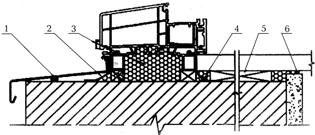
1 – шумопоглощающая прокладка; 2 – водоизоляционная паропроницаемая лента; 3 – пенный утеплитель; 4 – пароизоляционная лента; 5 – несущая опорная колодка; 6 – герметик
