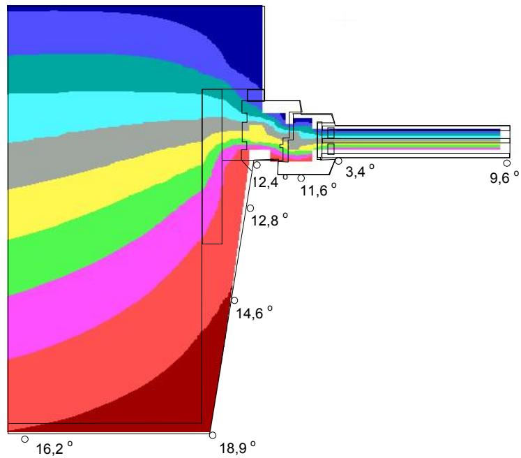
Рисунок Г.3 – Результаты расчета распределения температур по узлу примыкания оконного блока из kleеной древесины к стене из полнотелого кирпича
