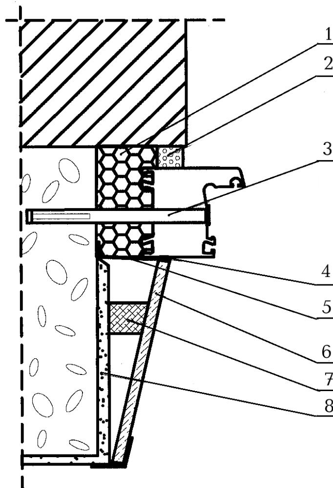
1 – пенный утеплитель; 2 – изоляционная саморасширяющаяся паропроницаемая лента; 3 – рамный дюбель; 4 – герметик; 5 – пароизоляционная лента; 6 – панель отделки внутреннего откоса; 7 – рейка; 8 – штукатурный выравнивающий слой внутреннего откоса
