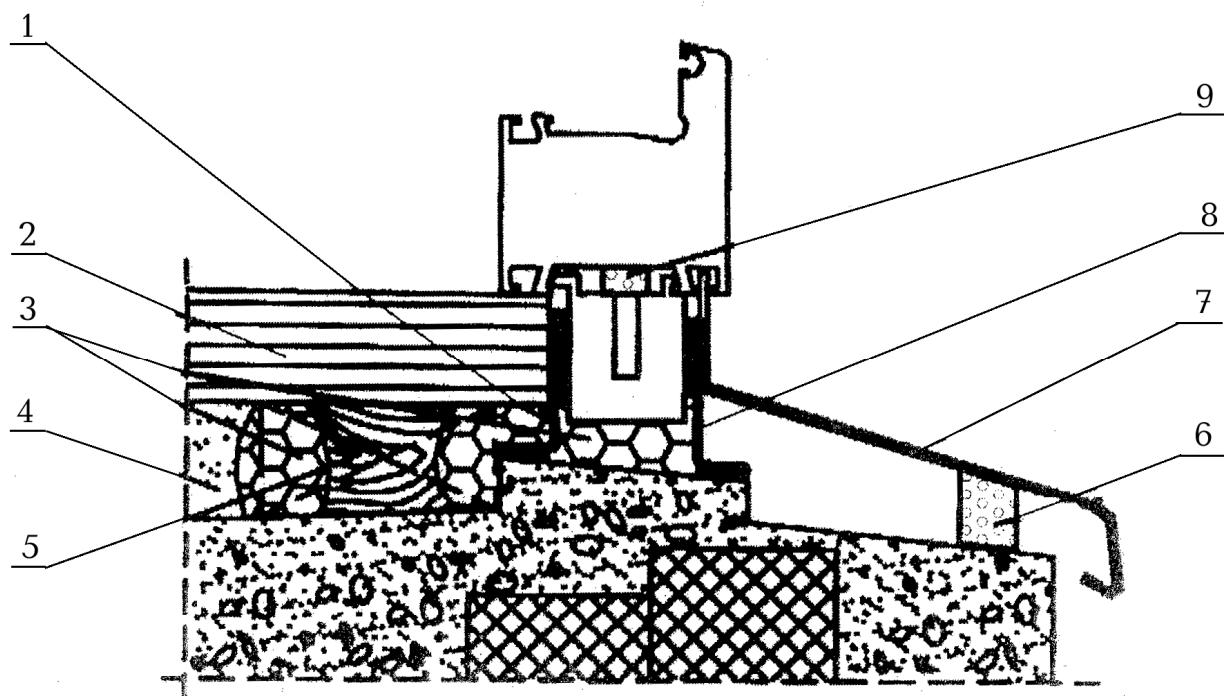
1 – пароизоляционная лента; 2 – подоконная доска; 3 – пенный утеплитель; 4 – штукатурный раствор; 5 – опорная колодка подоконной доски; 6 – шумогасящая прокладка; 7 – слив; 8 – водоизоляционная паропроницаемая лента; 9 - изоляционная саморасширяющаяся паропроницаемая лента;
