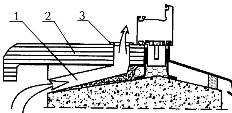
1 – канал подачи теплого воздуха от нагревательного прибора к оконному блоку (штроба в стяжке из штукатурного раствора); 2 – подоконная доска; 3 – декоративная решетка выходного отверстия
