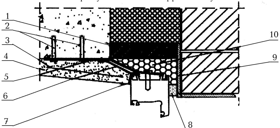
1 – вкладыш из атисептированного пиломатериала; 2 – дюбель со стопорным шурупом; 3 – армирующая сетка; 4 –штукатурный слой внутреннего откоса (с фаской для слоя герметика), возможна отделка листовым материалом (влагостойкая панель); 5 – гибкая анкерная пластина; 6 – пароизоляционная лента; 7 – герметик; 8 – изоляционная саморасширяющаяся паропроницаемая лента; 9 – стальная перемычка с антикоррозионным покрытием; 10 – пенный утеплитель;
