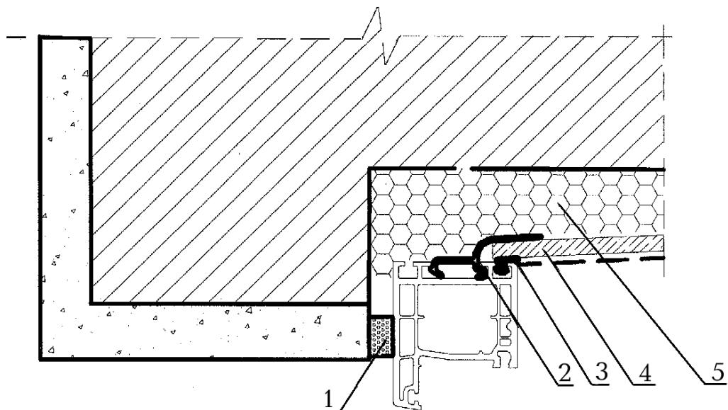
1 – изоляционная саморасширяющаяся паропроницаемая лента; 2 – дополнительный профиль;
