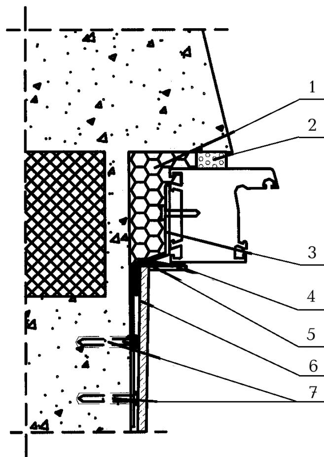
1 – пенный утеплитель; 2 – изоляционная саморасширяющаяся паропроницаемая лента;
