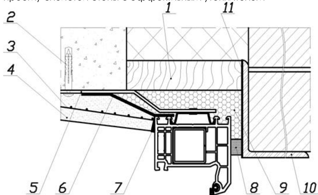
1 – вкладыш из атисептированного пиломатериала; 2 – дюбель со стопорным шурупом; 3 – армирующая сетка; 4 – штукатурный слой внутреннего откоса (с фаской для слоя герметика), возможна отделка листовым материалом (влагостойкая панель); 5 – гибкая анкерная пластина; 6 – пароизоляционная лента; 7 – герметик; 8 – изоляционная саморасширяющаяся паропроницаемая лента (ПСУЛ); 9 – пенный утеплитель; 10 – стальная перемычка; 11 – антикоррозийное покрытие
