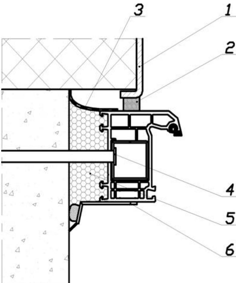
1 – элемент отделки наружного оконного откоса; 2 – изоляционная саморасширяющаяся паропроницаемая лента (ПСУЛ); 3 – водоизоляционная паропроницаемая лента; 4 – рамный дюбель; 5 – пенный утеплитель; 6 – нащельник из ПВХ в комбинации с пароизоляционным вкладышем
