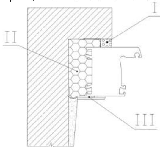
I – наружный водоизоляционный паропроницаемый слой;
