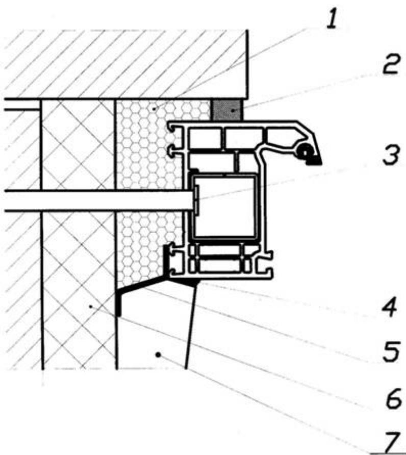
1 - пенный утеплитель; 2 - изоляционная саморасширяющаяся паропроницаемая лента (ПСУЛ); 3 – рамный дюбель; 4 – герметик; 5 – пароизоляционная лента; 6 – компенсатор монтажного зазора (рекомендуется для утепления откоса в зданиях старой постройки, может применяться для утепления откоса и изоляции пенного утеплителя от плоскости возможной конденсации); 7 – штукатурный слой внутреннего откоса (с фаской для слоя герметика)
