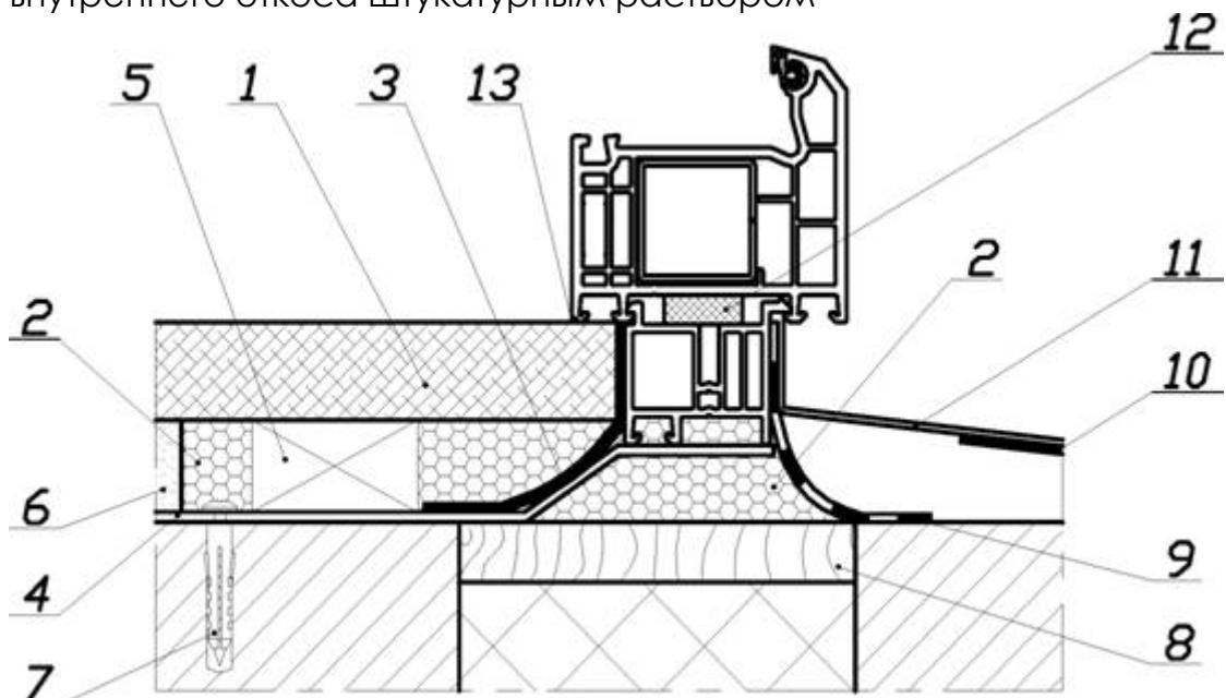
1 - подоконная доска; 2 - пенный утеплитель; 3 - пароизоляционная лента; 4 - гибкая анкерная пластина; 5 - опорная колодка под подоконную доску; 6 - штукатурный раствор; 7 - дюбель со стопорным шурупом; 8 - вкладыш из антисептированного пиломатериала или выравнивающий слой из штукатурного
