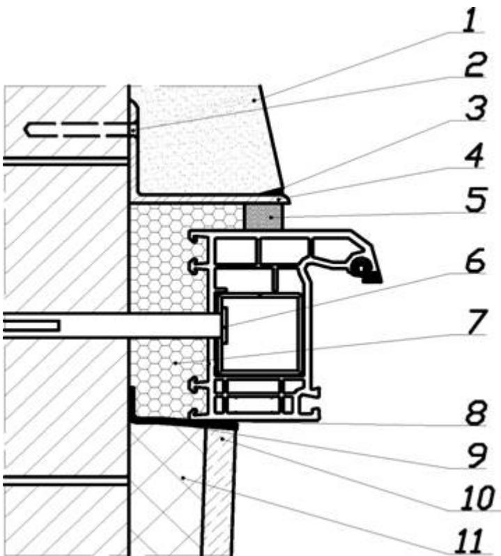
1 – штукатурный слой наружного откоса (с фаской для слоя герметика); 2 – строительный шуруп; 3 – герметик; 4 – фальшчетверть из уголка; 5 – изоляционная саморасширяющаяся паропроницаемая лента (ПСУЛ); 6 – рамный дюбель; 7 – пенный утеплитель; 8 – герметик; 9 – пароизоляционная лента; 10 – элемент отделки внутреннего откоса; 11 – полость между неутепленной однослоиной стеной и элементом отделки откоса (рекомендуется заполнять теплоизоляционным материалом)
