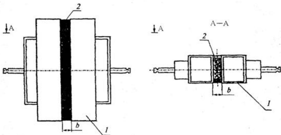
$b$  - толщина шва; 1 - обойма из алюминия или нержавеющей стали толщиной 3 мм; 2 - образец испытуемого монтажного шва
